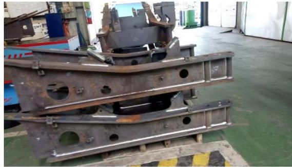
**Gambar 1. Gambar Komponen Tail Frame**
